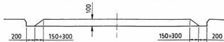
Rys. 2. Progi liniowe o zmniejszonej szerokości (progi skrócone)
